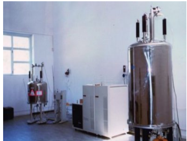
Foto 1: Centro di Risonanza Magnetica Nucleare (NMR): Spettrometro FT-NMR UNITY INOVA TM Narrow Bore NMR 500 MHz.
