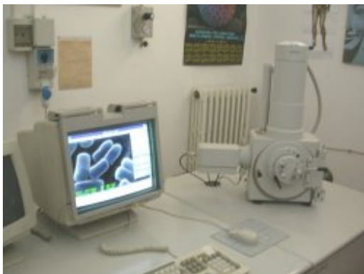
Foto 2: Microscopio elettronico a scansione (Philips SEM XL20). Dotazione dello strumento: rivelatore di elettroni secondari, rivelatore di elettroni retrodiffusi (back scattered), sistema di Analisi d'immagine XL - Docu (Soft Imaging System).
